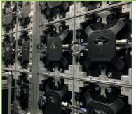
Les dalles sont alignées au moyen d'aimants tandis que deux connecteurs manuels permettent de les connecter les unes aux autres.
