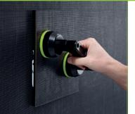
Le **GEKKO** est un outil que nous avons conçu spécialement afin que vous puissiez remplacer facilement les panneaux LED par l'avant.
