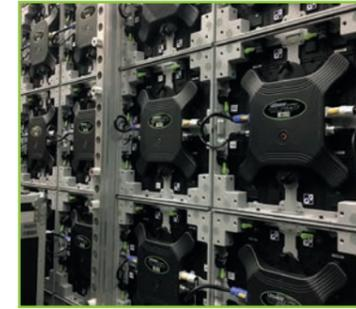
Die Ausrichtung erfolgt mit Hilfe von **Präzisionsstiftsystemen**, während manuelle Verbinder eine starke Verbindung zwischen den verschiedenen Systemen und Platten garantieren.
