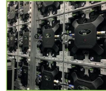
Les dalles sont alignées au moyen d'aimants tandis que deux connecteurs manuels permettent de les connecter les unes aux autres.
