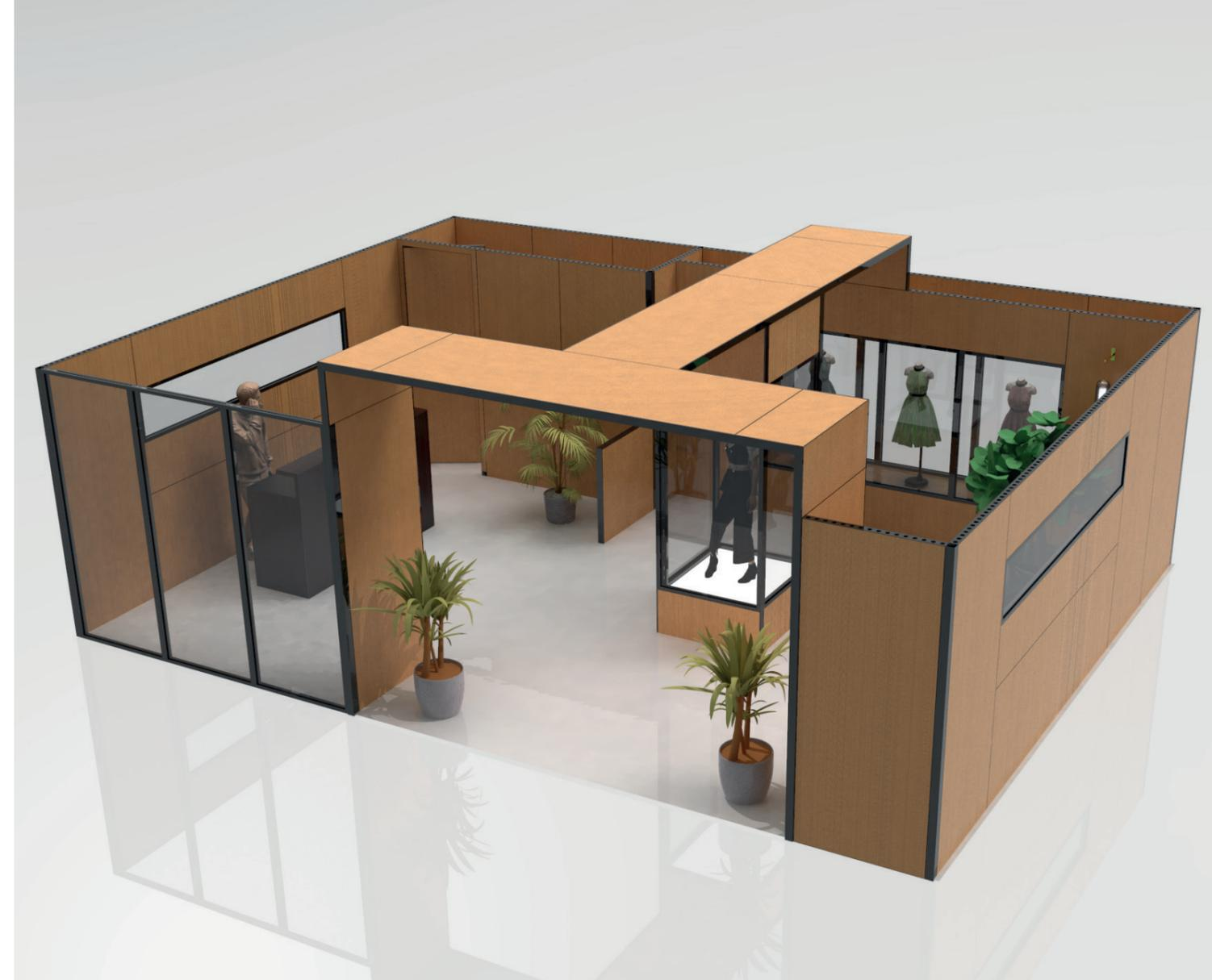
Outre le cadre soudé, vous pouvez également construire votre stand avec **des profilés séparés**. Leur principal avantage : les bords des profilés entre les sections de verre sont invisibles. Le bord du verre doit toutefois être suffisamment solide, notamment grâce à un profilé d'angle posé sur les profilés de verre.
