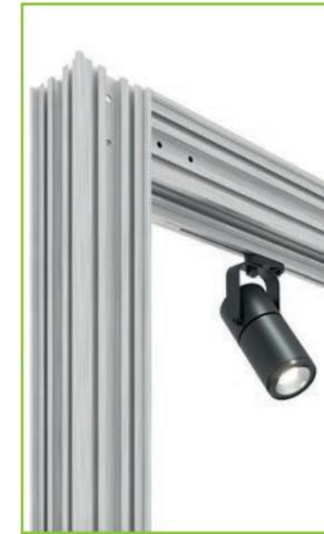
Ajouter éclairage à votre projet est un jeu d'enfant. La section transversale du profilé beConstruct comporte une encoche permettant d'y glisser un **profilé Track Light**. Encore mieux : il y a un canal à l'intérieur où vous pouvez cacher les câbles. Ils sont fixés à l'aide d'un clip.
