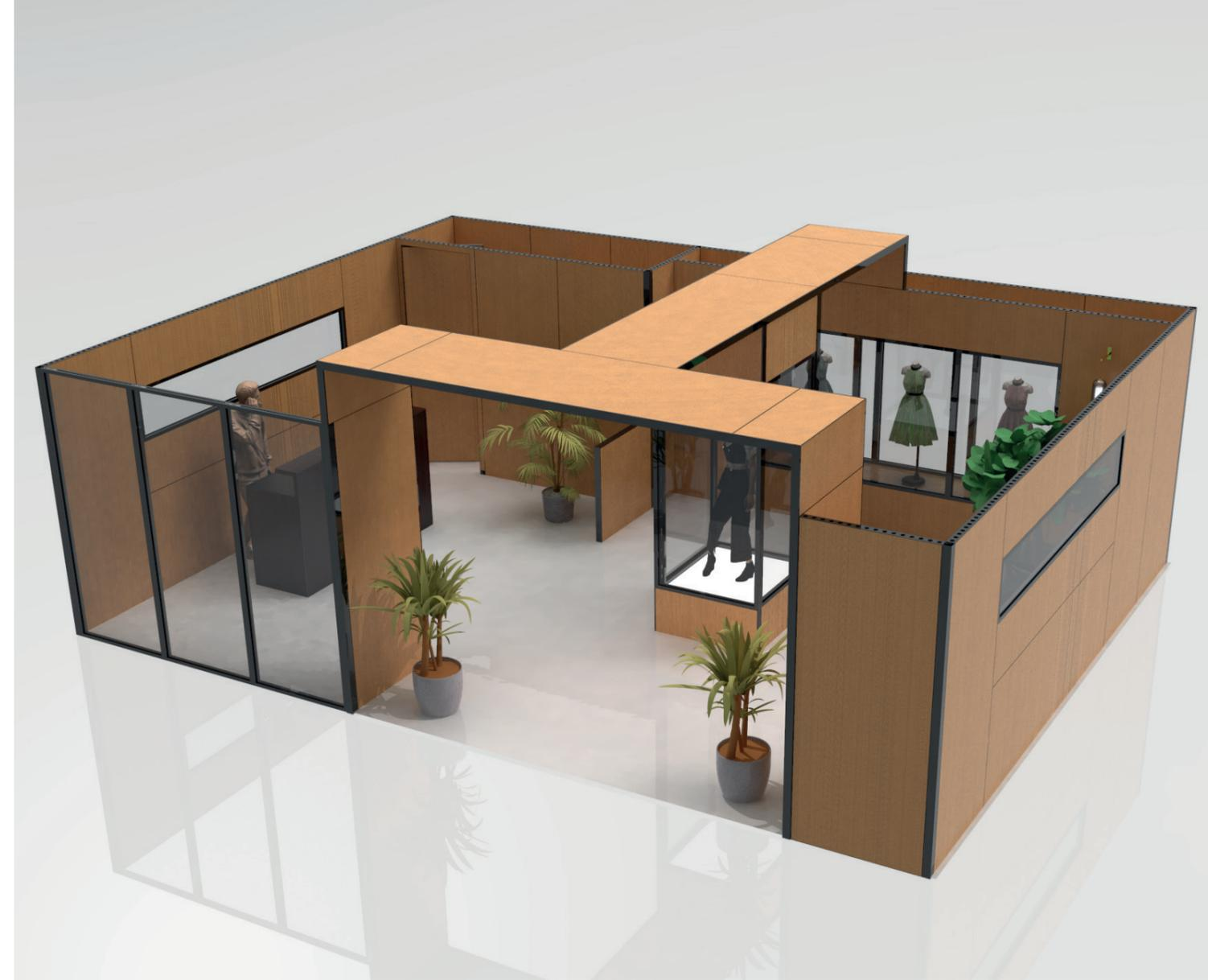
Neben dem geschweißten Rahmen haben Sie auch die Möglichkeit, mit **losen Profilen** zu bauen. Der große Vorteil: Es gibt keine sichtbaren Profilkanten zwischen den Glaselementen. Wichtig ist hierbei jedoch, dass Sie für ausreichend Stabilität rund um das Glas sorgen, z.B. mit einem Eckprofil auf den Glasprofilen.
